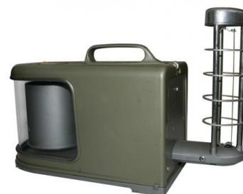
Plus l'air est humide, plus le cheveu s'allonge. Plus l'air est sec, plus le cheveu se raccourcit. Les modifications de longueur enregistrées sur le tambour permettent de tracer le taux d'humidité de l'air au cours du temps.
