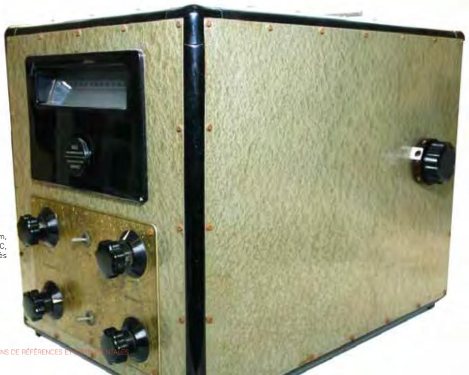
Photomètre de flamme (hauteur : 50 cm, largeur : 35 cm, profondeur : 52 cm) © PATSTEC, Université Toulouse Jean Jaurès
