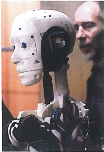
Alterego. Le robot open source InMoov pourra être imprimé en 3D chez soi.
